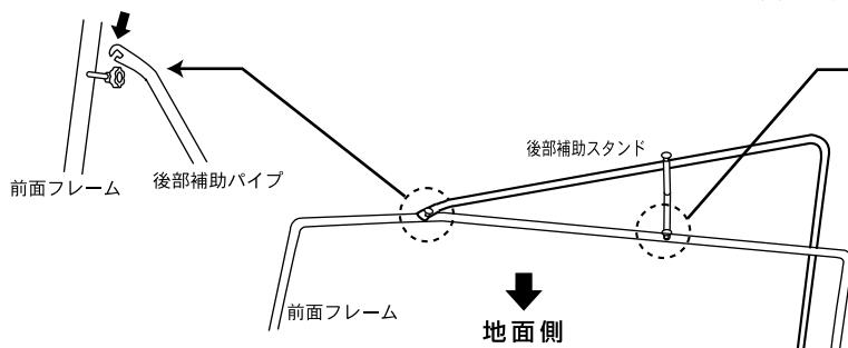
2. パイプのツマミを外し、パイプのネジに連結金具を差し込み、ツマミで締めて固定します。
