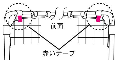
ネットの赤いテープが前面の上部左右の両端にくるようにセットします。
