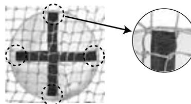
的の裏側のベルトを開放し、各ベルトの折り返し部分のネット目一本のみを挟み固定します。(二重ネットの正面側のネットのみに取り付けます。)
